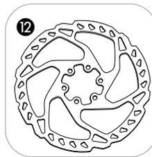
**Nei freni a disco:** il disco del freno **12** è montato sul mozzo e il fissaggio del freno sul telaio o sulla forcella. Vi sono due tipi di freni a disco: a trasmissione meccanica o idraulica. La regolazione dei freni può essere effettuata solo sul fissaggio del freno. Questo intervento dovrebbe essere eseguito preferibilmente in un'officina specializzata.
