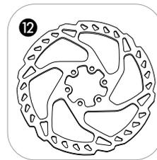
**Sur les freins à disque**, le disque de freins **12** est monté sur le moyeu et l'étrier sur le cadre ou la fourche. Il existe deux sortes de plaquettes de frein: à transmission mécanique ou hydraulique. Le réglage des freins se fait uniquement sur l'étrier. Confiez de préférence ce travail à un atelier spécialisé.
