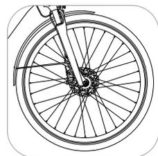
Sur la bicyclette, les roues subissent des contraintes particulièrement importantes. Avec la jante, le moyeu, les rayons, le plat de jante, la chambre à air et le pneu, les roues constituent une unité essentielle de la bicyclette. En contact avec le sol, elles sont soumises à d'importantes contraintes en raison des inégalités de la chaussée et du poids du cycliste. Voilà pourquoi il est indispensable de les faire contrôler et de les entretenir
