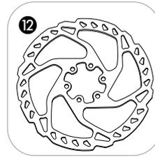
Bei **Scheibenbremsen** ist die Bremscheibe **12** an der Nabe und der Bremsattel am Rahmen oder an der Gabel montiert. Es gibt zwei Arten von Scheibenbremsen: mit mechanischer oder mit hydraulischer Kraftübertragung. Die Einstellung der Bremse kann nur am Bremsattel vorgenommen werden. Diese Arbeit lässt man am besten in einer Fachwerkstatt ausführen.
